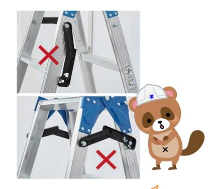
開き止めが外れていないか脚立 がしっかり開いているか確認しよ 脚子 り。 損傷している部分がないかも 点検しよう。
